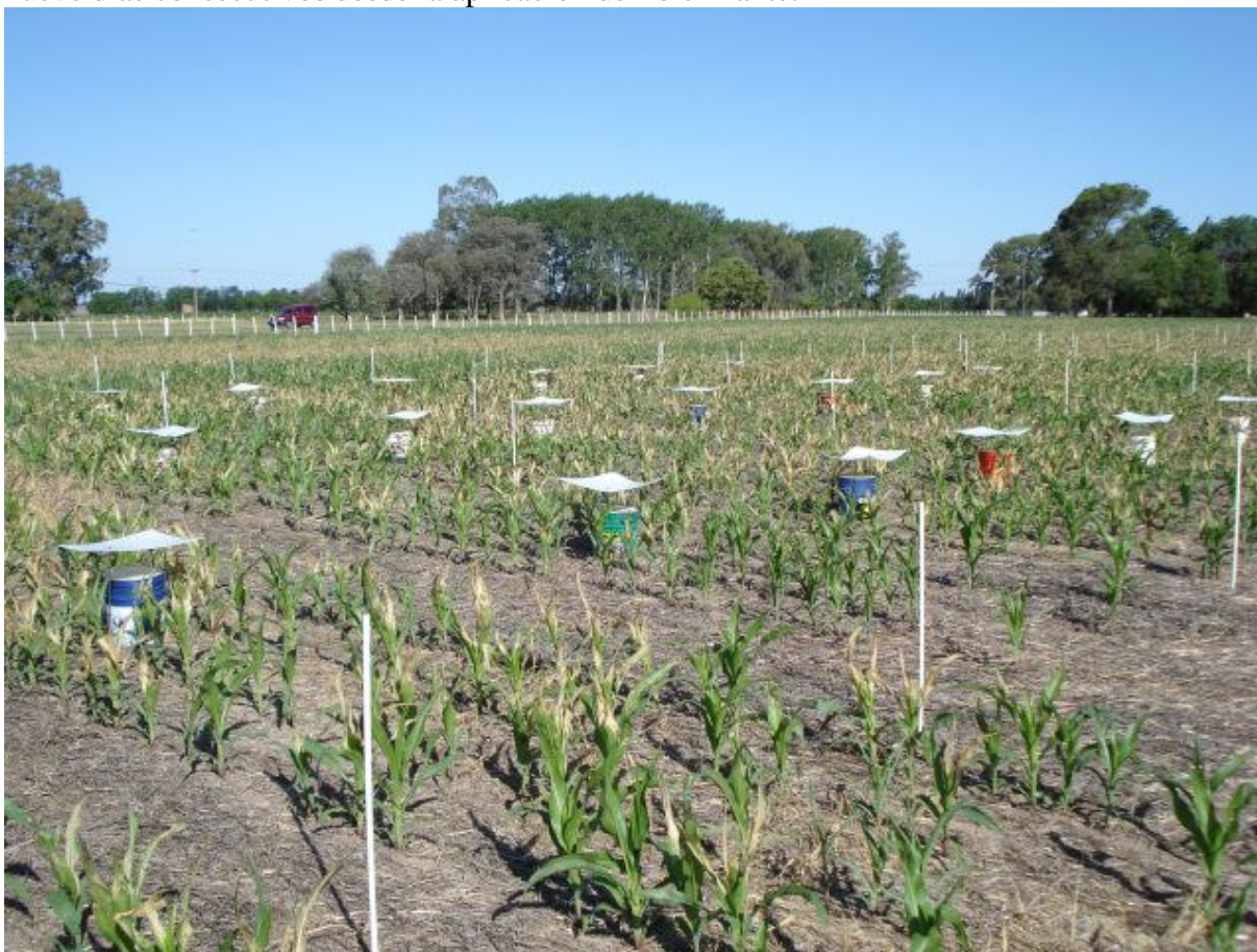
Fotografía 1: Medición de emisiones de N en forma de NH 3 . INTA EEA Pergamino, Noviembre de 2008
